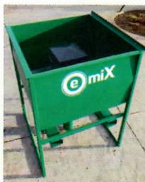
Emix est une trémie intermédiaire qui mélange les granulés anti-limaces et les semences, opération jugée souvent fastidieuse par bon nombre d'agriculteurs. Une trémie emboîtée réalise l'incorporation par gravité, respectant ainsi l'intégrité des produits. L'utilisateur n'est plus en contact direct avec les granulés. Le mélange obtenu est homogène, ce qui garantit la régularité du semis et la protection anti-limaces.
