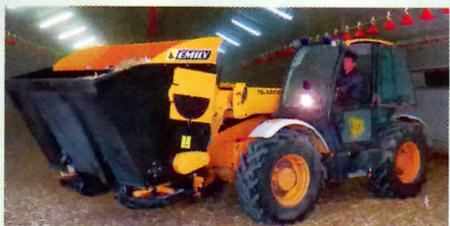
Adaptable sur chargeur frontal, 3 points AR et télescopique, le godet Multi'Spread épand tout type de produits légers destinés aux litières des animaux. Il évite le changement d'outil pour les exploitations laitières disposant d'un atelier volailles. Il passe d'un produit à l'autre en toute simplicité. Une crosse d'éjection brevetée réduit l'angle de paillage à 21°.
